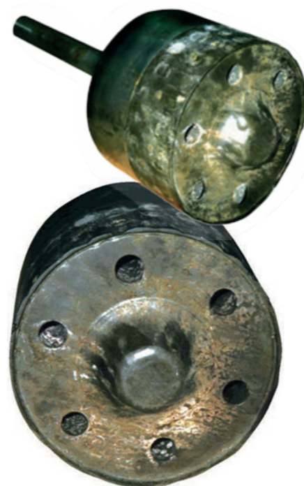
Interno de LCV de carbeto de tungstênio sólido patenteado após dois anos de operação
