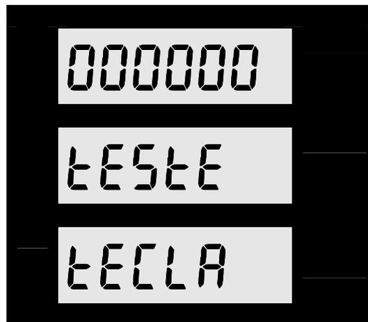
Para verificação de cada tecla, basta apertá-la, e o seu respectivo número deve aparecer no campo superior. Para interromper o teste basta pressionar a tecla ESC. Se desejarmos abandonar o menu de SETUP, basta apertarmos a **tecla ESC** novamente.
