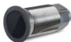
A sonda cria pulsos ultrassônicos na lama e registra o eco refletido. Consiste num elemento piezoelétrico de alta precisão ligado a um elemento sensor de cerâmica. A vibração do elemento cerâmico é transferida para o meio e refletida. Este eco de interface é convertido pelo elemento piezo em um sinal de tensão, que é digitalizado pelo transmissor.
