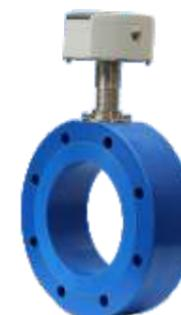
O wafer padrão é feito de UPE-1000 (poliuretano de alto peso molecular). Está preso entre os flanges do tubo. Este wafer é projetado para baixas pressões (até 7 bar) e baixas temperaturas (até 55 ° C). Os wafers são projetados para cada tubo individualmente, pois o tamanho dos flanges e o diâmetro interno do wafer devem se corresponder. Um wafer bem projetado não se desgasta.
