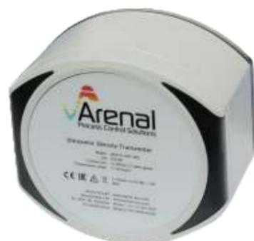
O transmissor controla a sonda de densidade ultrassônica de cerâmica. Sua função é enviar pulsos de alta tensão para a sonda, digitalizar e analisar os reflexos do eco. Em tempo real as propriedades acústicas são calculadas e esses valores são transmitidos ao Analisador S101.
